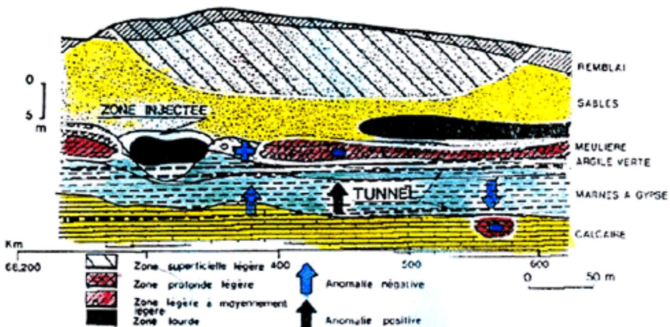
Fig.: 7. TUNNEL DE BREVAL. Endosseis microgravimétrique (EMG). Régression à 11 densités
